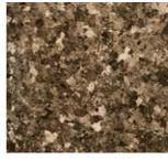
チタンの結晶粉(小)をテクスチャーとして、アン ティークゴールドに仕上げたものです。 ※板厚:0.4mm
