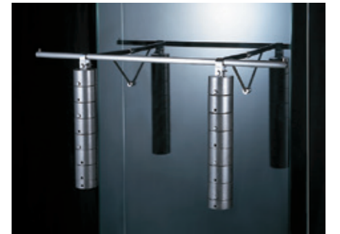
ソロフォースアームハンガー 60kg 荷重テスト Solo Fourth Arm Hanger 60kg(132.45 lbs) Loading Test
