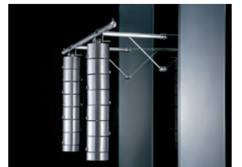
ソロフェイスアウトセーフティブラケット 15kg 荷重テスト Solo Faceout Safety bracket 15kg(33.11 lbs) Loading Test
