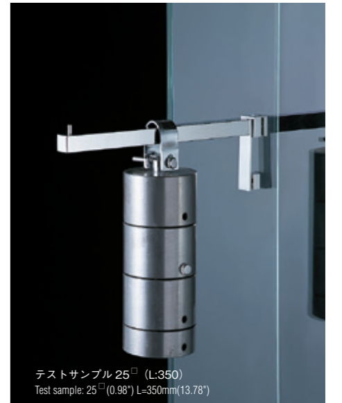
ソロフェイスアウトセーフティブラケット 15kg 荷重テスト Solo Faceout Safety bracket 15kg(33.11 lbs) Loading Test
